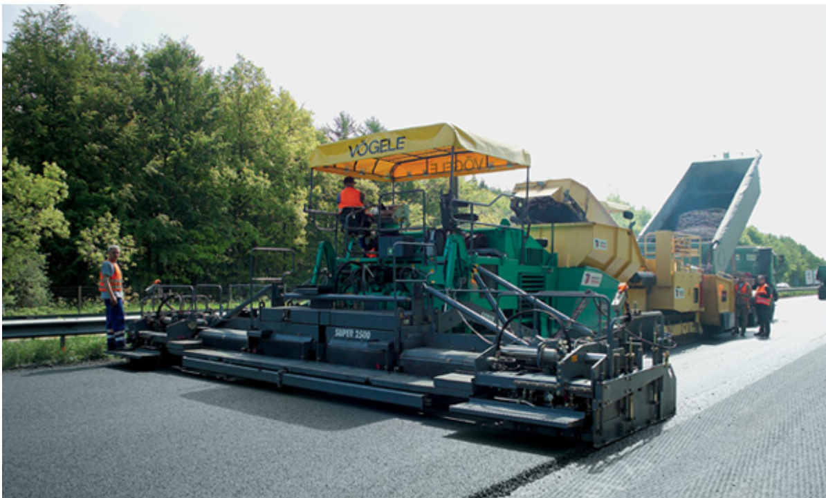
Finišer Vögele SUPER 2500 z visoko zmogljivostno desko SB 250 TP2
